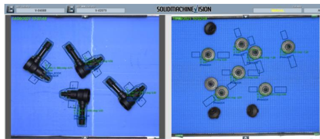
Figura 6.3: Àrea principal de visualització pel guiament d'un robot pick and place . Font: [36].
