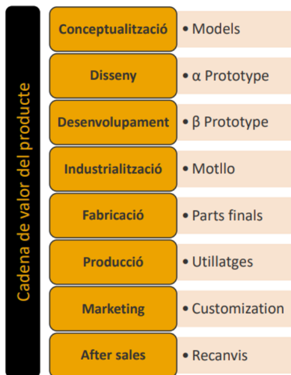
Figura 2.6: Fabricació Additiva aplicada a la cadena de valor d'un producte. Font: [15].
