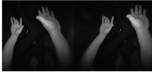
Figura 28. Dades capturades per Leap Motion Font: Ultraleap
