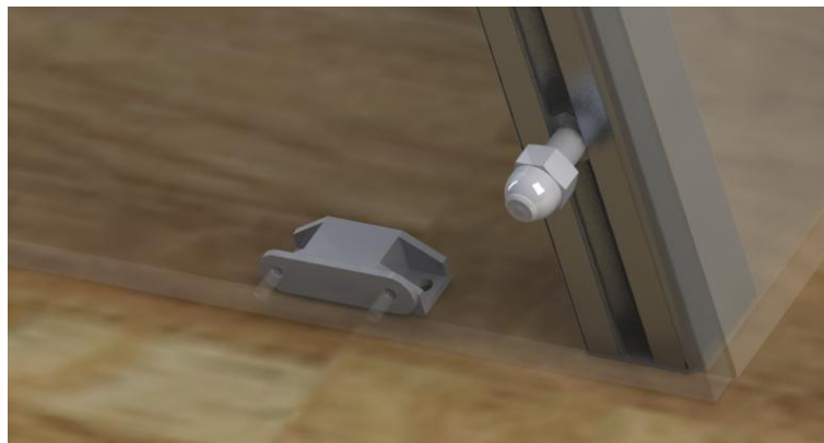
Figura 5.7. Dispositiu de tancament senzill per imants.
