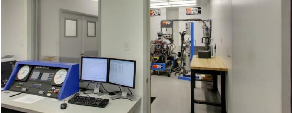
Figura 3.1 Una sala per a proves de motors annexada a la sala de control.
