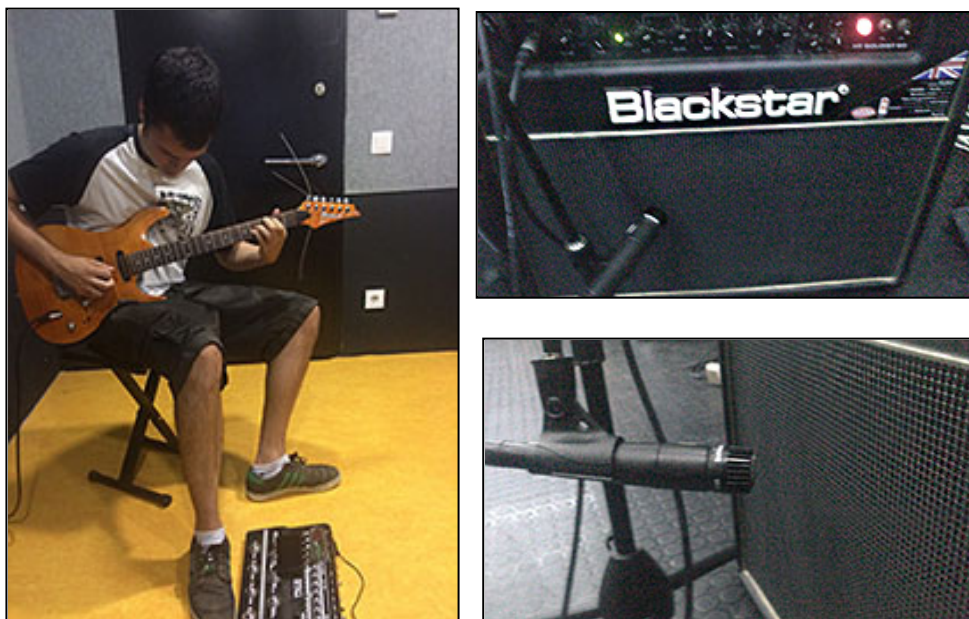
Fig. 6.9. Posicionament del micròfon per la gravació de les guitarres.
