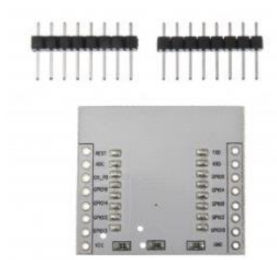
Figura 26. Placa adaptadora al mòdul ESP-12F
