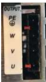
Fig. 5.3. Terminal d'alimentació elèctrica de la Kinetix pel motor.
