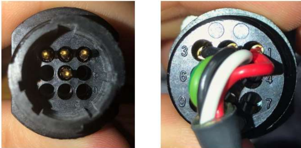
Fig. 5.10. Connector de potència físic del TLY. Font: Rockwell literature
