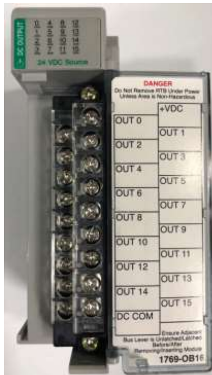
Fig. 6.7. Informació terminals de connexió de la 1769-OB16.
