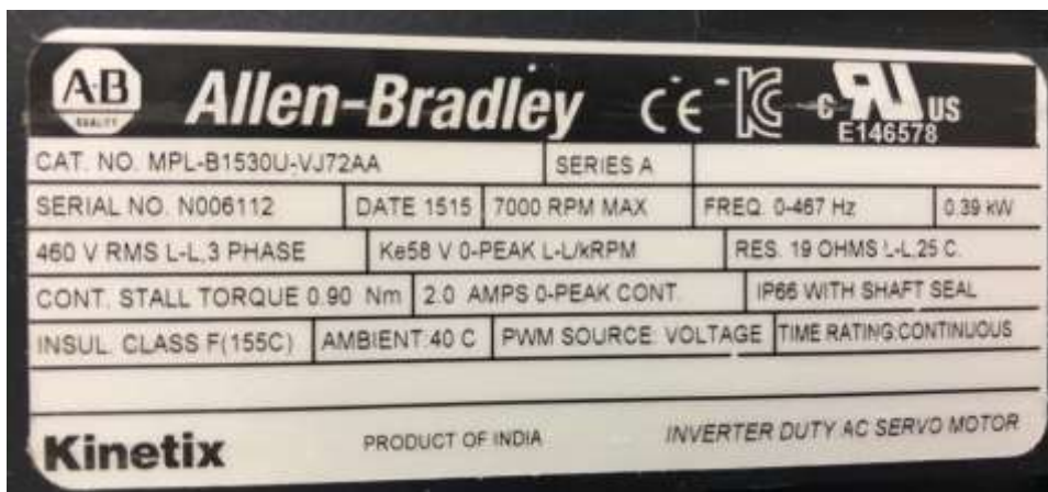
Fig. 2.2. Especificacions motor MPL. Font: Elaboració pròpia
