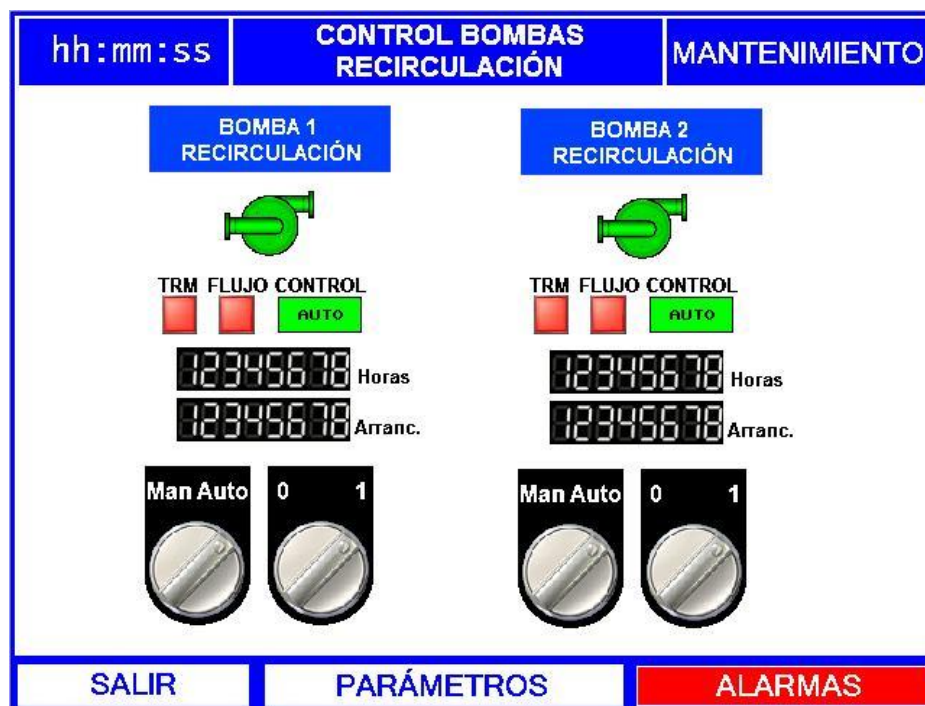
Figura 6-5: Pantalla control bombas de recirculación Fuente: Propia
