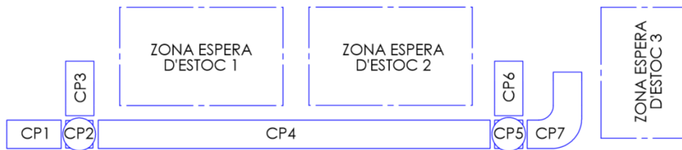
Figura 6.2. Plànol distribució cintes transportadores de producció.
