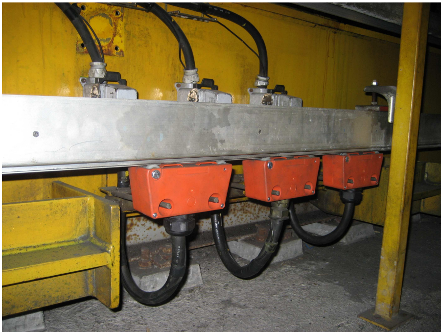
Figura 3.2. Carros mòbils de presa de corrent dels transelevadors (Font: Elaboració pròpia)
