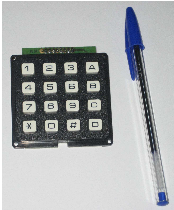
Figura 5.23. Teclat matricial 4x4 (Font: Elaboració pròpia)
