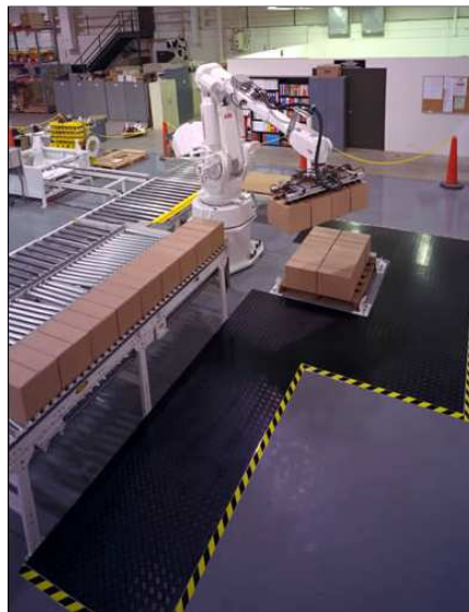
Figura 34: Estores de seguretat envoltant area de perill
