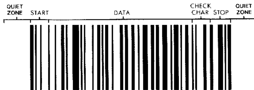
Figura 2.9 Áreas de un código de barras
