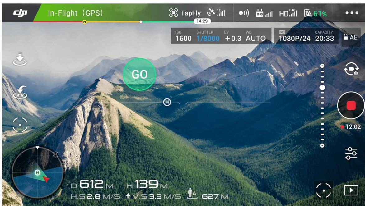
Fig. 3.7. Interfaz de control de la aplicación DJI Go 4. (DJI, 2021).
