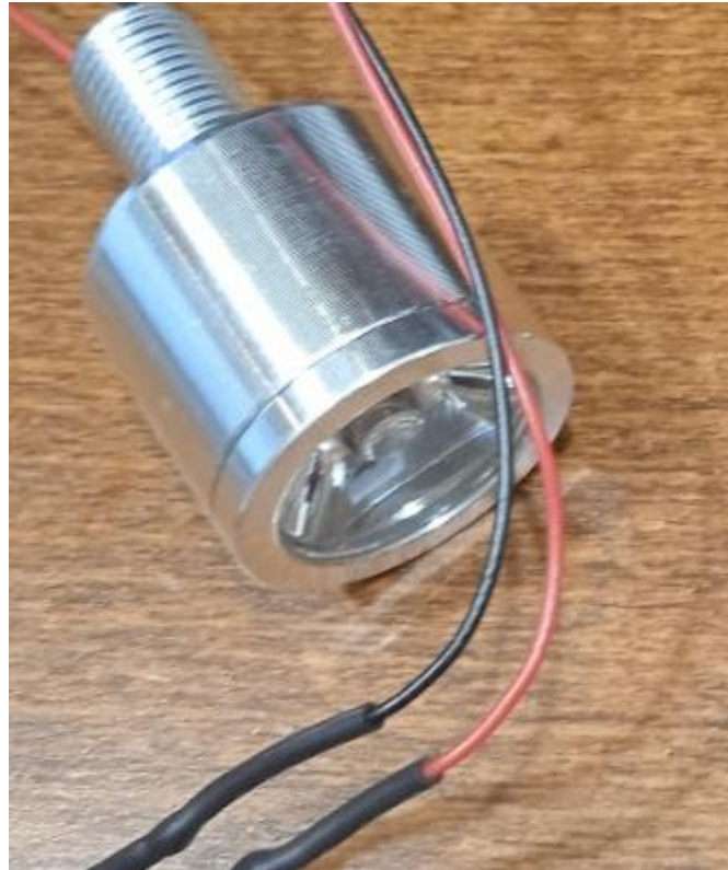
Il·lustració 5.1.1.7 - Fotografia del llum led, fa una funció semblant a una llanterna. Font: Elaboració pròpia
