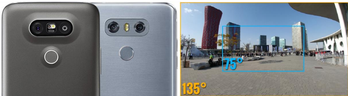
Fig. 3.3.6. Esquerra: LG G5 i LG G6. Font: LG 2016 i 2017. Dreta: Comparativa del camp de visió de les càmeres del LG G5. Font: GSMarena.com, 2016.
