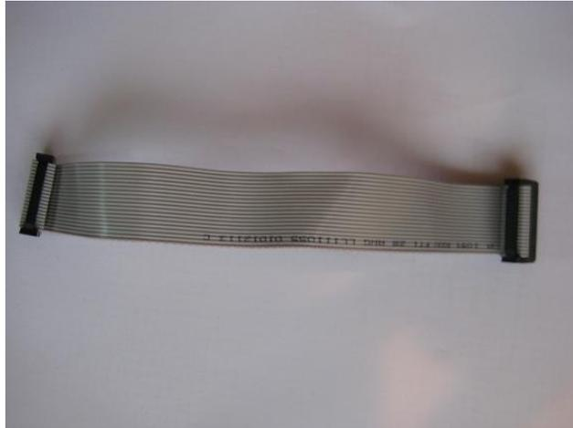
Figura 4.3.5: Conector placa tratamiento de señales al periférico del módulo ADC eZdsp F28335.
