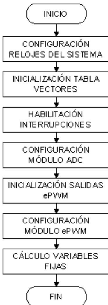
Figura 4.2.3.: Diagrama de bloques del módulo de programa *main.c*.
